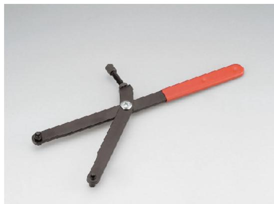
クラッチセンターナットを外す際に、フライホイールを固定するのに使用。クラッチアウター、フロントスプロケットなどの脱着の際の空回り防止する特殊工具。
