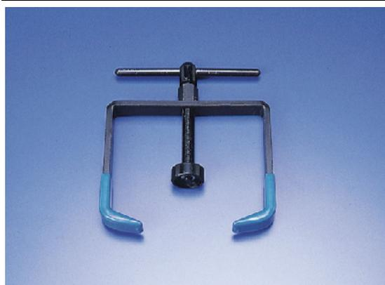
センタースプリングの脱着の際にスプリングテンションを押さえ、作業効率をアップさせる特殊工具。クラッチスプリング、センタースプリング、クラッチシューの組み付け・取り外しに。センターナットの取り外しには、別途下記フライホイールホルダーとロックナットレンチが必要です。
